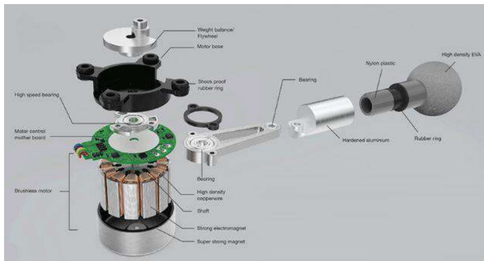
شکل ۲. مکانیزم کلی ماساژور تفنگی.
